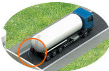
Figura 11. Imagem do reabastecimento to tanque de armazenamento de GNL.
